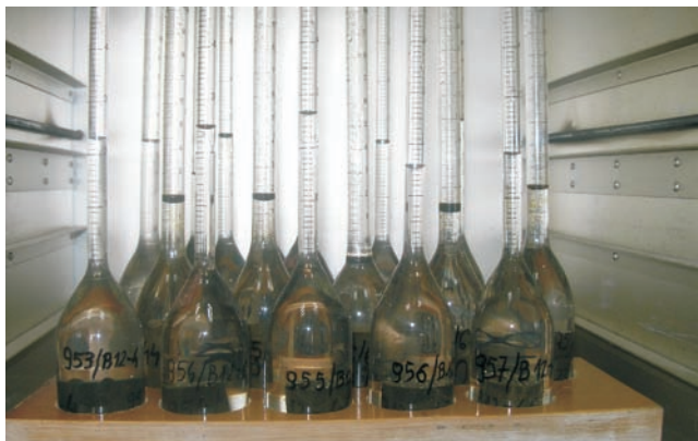
Fot. 1. Widok naczyń szklanych do pomiaru efektu wypierania ropy wodą, wraz z umieszczonymi rdzeniami. Zestaw umieszczono w komorze termostatycznej, w temperaturze badania 60°C
