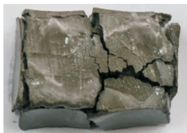
Fot. 5. Próbka skały ilastej po 48-godz. oddziaływaniu płuczki potasowo-polimerowej
