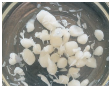
Fot. 1. Interakcje polimeru kationowego o działaniu przeciwyhydratacyjnym z roztworem bentonitu
