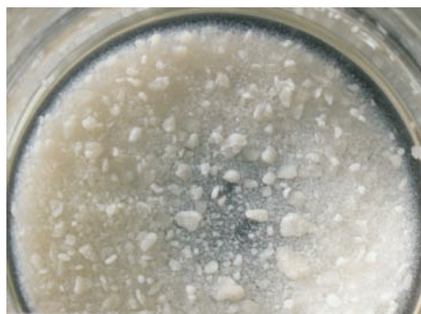
Fot. 2. Interakcje polimeru kationowego o działaniu przeciwpęczniącym z roztworem bentonitu
