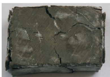
Fot. 6. Próbka skały ilastej po 48-godz. oddziaływaniu płuczki krzemianowo-potasowej
