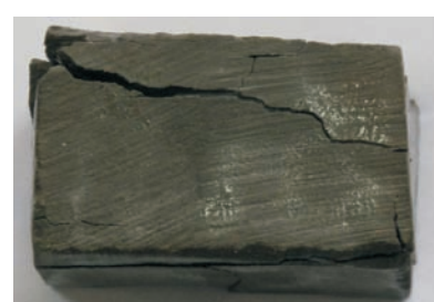
Fot. 7. Próbka skały ilastej po 48-godz. oddziaływaniu płuczki KL/CDRW 640
