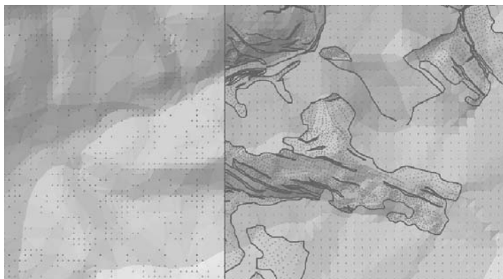
Rys. 3. Niejednorodność danych w TBD w zakresie NMT (źródło: WODGiK)
