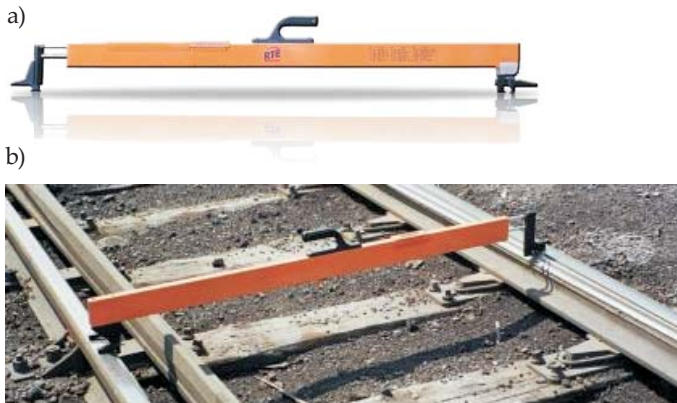
Rys. 5. Ręczny toromierz elektroniczny RTE 2 firmy PROVENTUS: a) widok z przodu; b) widok podczas pomiaru rozjazdu
