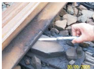
Rys. 4. Szczelinomierze do sprawdzania przylegania iglic do płyt ślizgowych
