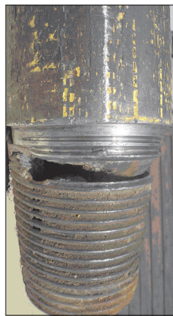
Rys. 9. Częstka stali w gwincie czopa
