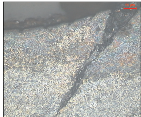
Rys. 5. Wyraźnie zniekształcony profil gwintu w pobliżu pęknięcia w czwartym rowku
