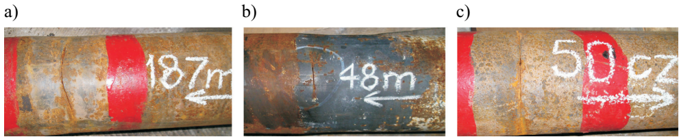
Rys. 2. Pęknięcie rury 187 (a) na początku spęcznienia jej końca w odległości 47,6 cm od czoła mufy, rury 48 (b) na początku spęcznienia jej końca w odległości 46,4 cm od czoła mufy oraz rury 50 (c) w caliznie w odległości 100 cm od czoła czopa
