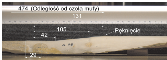
Rys. 6. Wymiary profilu wewnętrznego zdjęte z odlewu rury nr 58 w płaszczyźnie jej pęknięcia
