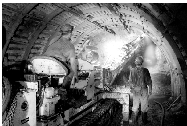
Rys. 5. Drażenie jednego z przekopów na poz. 700 m w KWK „Jankowice” z wykorzystaniem wozu wiertniczego VVH-1U
