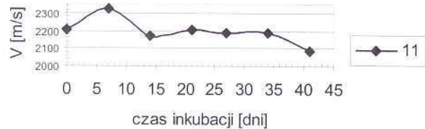
RYS.4. Zależność zmiany prędkości fali ultradźwiękowej po długości łopatek z kopolimeru P(LLA/GLA) od czasu inkubacji w płynie Ringera.
