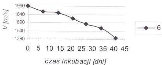
RYS.2. Zależność zmiany prędkości fali ultradźwiękowej po długości śruby z PLA od czasu inkubacji w płynie Ringera.
