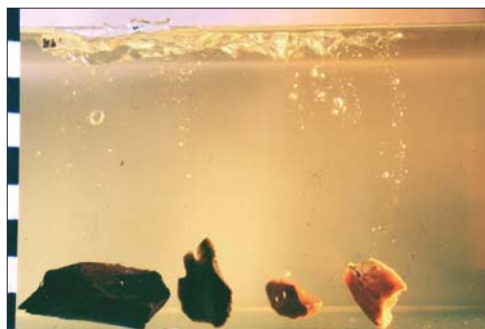
Fig. 6. Ostatnia faza grzęźnięcia. Wszystkie odłupki „stoją” pionowo, opierając się grubszymi końcami o dno akwarium. Od lewej: rdzeń, cienki odłupek, grubszy odłupek i gruby odłupek
