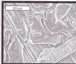
RYS.5. Kompozyt węgiel-węgiel typu 2D z powłoką węgla szkłopodobnego na powierzchni FIG.5. Carbon - carbon composite of 2D type coated with glass - like carbon layer
