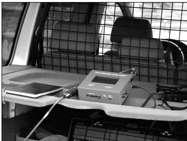
Rys. 5. Badanie dynamiczne nośności
