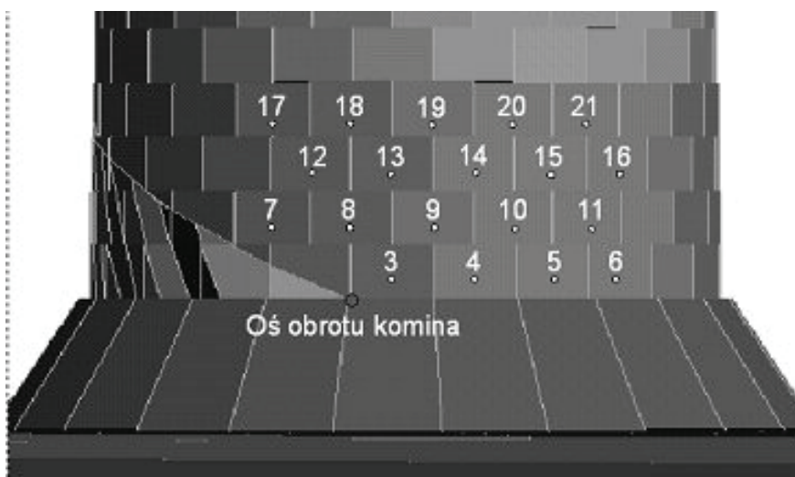
Rys. 3. Strefa włomu (po lewej) i stopa oporowa komina
