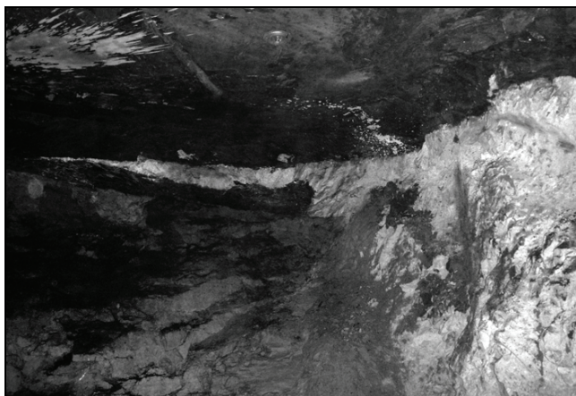
Rys. 7. Subhoryzontalne odklucie w obrębie piaskowców podkreślone łupkiem w rejonie skrzyżowania komory K-1b z pasem P-15 w polu eksploatacyjnym G-6/7 oddziału G-26 kopalni „Rudna”
