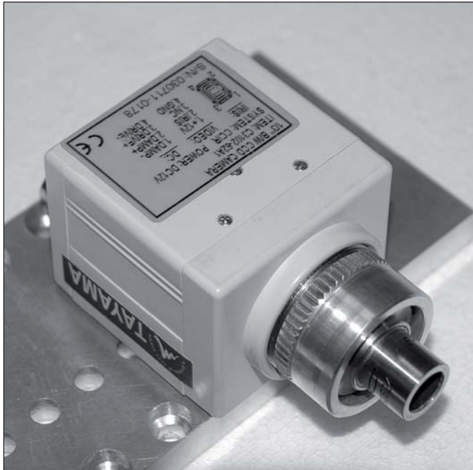
Rys. 6. Kamera CCD z obiektywem pomiarowym
