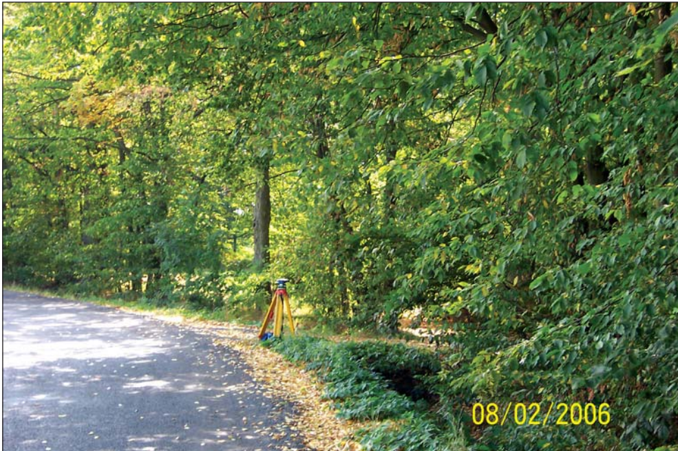
Rys. 2. Punkt osnowy szczegółowej, na którym nie otrzymano poprawnego rozwiązania przy dwukrotnym pomiarze GPS
