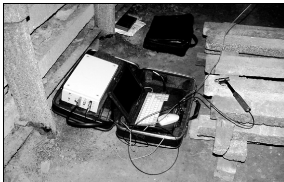
Rys. 2. Przenośny system pomiarowy, realizacja badań w warunkach rzeczywistych stosowania samodzielnej obudowy kotwiowej
