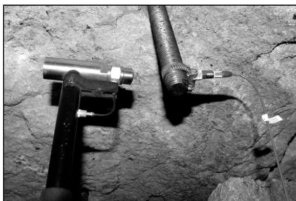
Rys. 3. Wymuszanie drgań młotkiem udarowym, sygnał odpowiedzi mierzony piezoelektrycznym przetwornikiem drgań
