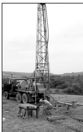
Rys. 1. Wiercenia rdzeniowe \varnothing 132 mm, Beskid Niski
