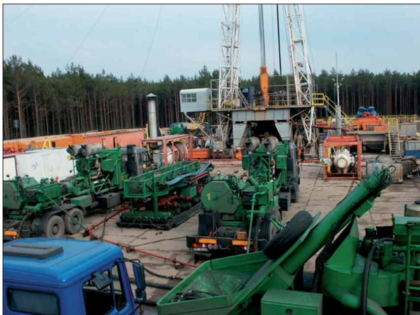
Rys. 10. Zabieg kwasowania matrycowego na złożu BMB
