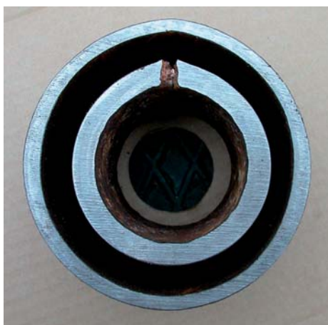
Rys. 9. Przebicie rury produkcyjnej bez naruszenia rury okładzinowej, ładunek zbrojący perforator – przebijak
