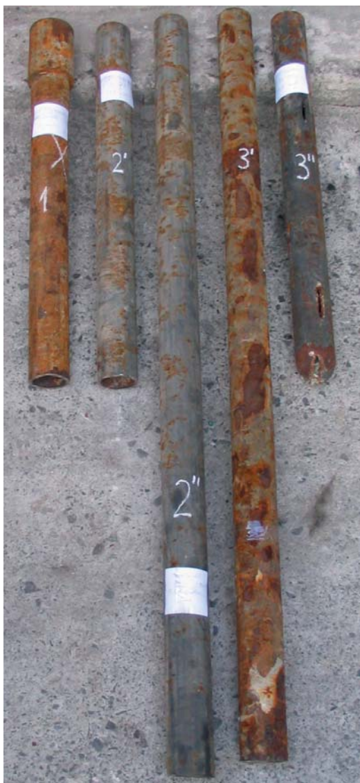
Rys. 2. Elementy rur wydobywczych 2\frac{7}{8} " przeznaczone do badań wytrzymałościowo-strukturalnych
