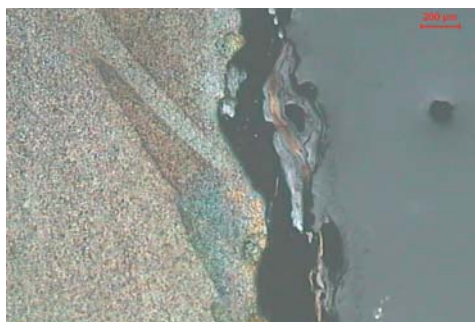
Rys. 15. Lokalne wżery na powierzchni wewnętrznej (rura nr 3')
