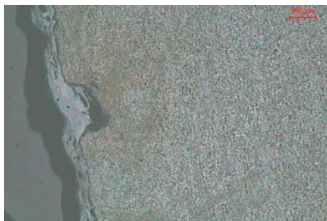
Rys. 13. Skorodowana powierzchnia wewnętrzna rury z widocznymi lokalnymi wżerami o głębokości ok. 0,3 mm (rura nr 3')
