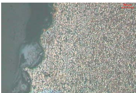
Rys. 16. Lokalne wżery obserwowane przy większym powiększeniu (rura nr 3')
