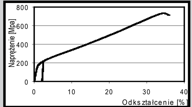
RYS.3. Przykładowy wykres naprężenie-odkształcenie kompozytu 316L +4%Cu+10%Ca 2 P 2 O 7 . FIG.3. Exemplary stress-strain curve of 316L+4%Cu+10%Ca 2 P 2 O 7 composite.
