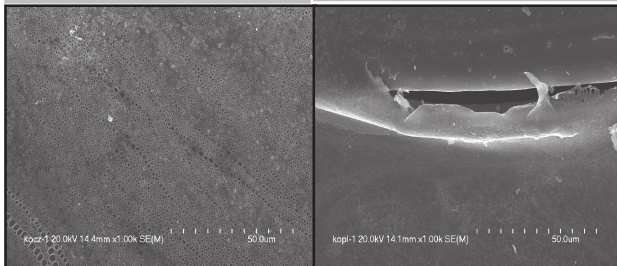
RYS. 3. Obraz SEM ompozytu (PP+PSU) poddanego działaniu plazmy H 2 O 2 . FIG.3. (PP+PSU) composite after plasma treatment.
