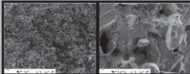
RYS. 4. Mikrostruktura tworzywa kalcytowego "2" (SEM, 500x). FIG. 4. Microstructure of calcite material coded "2" (SEM, 500x).
