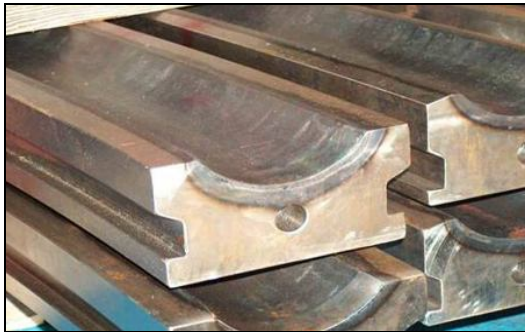
Rys. 6. Łoże kulowe po hartowaniu indukcyjnym
