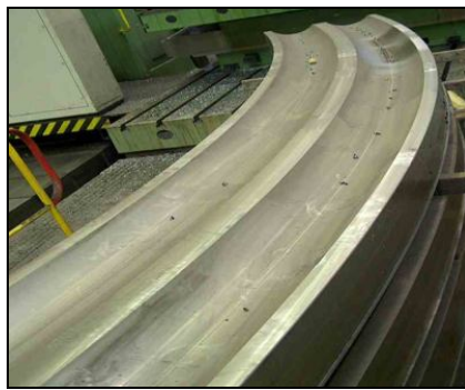
Rys. 3. Segment podwójnej bieżni kulowej
