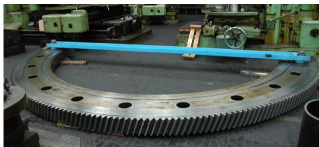
Rys. 11. Jedna z 4 części wieńca zębatego 6 m
