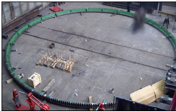
Rys. 8. Wieniec zębaty \text{Ø}11 m
