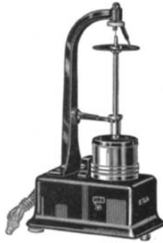
Rys. 3. Lepkościomierz MacMichaela działający na zasadzie kontrolowanego naprężenia (lata 30. XX w.) Źródło: Howard A. Barnes, Derek Bell, Korea-Australia Rheology Journal, vol. 15 [10]
