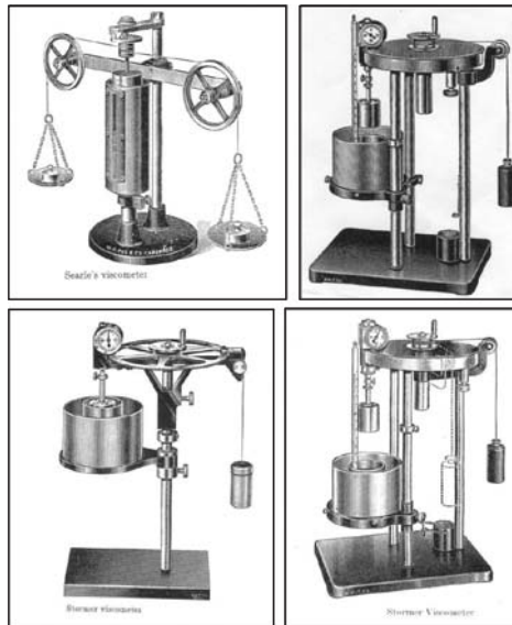
Rys. 2. Przykład lepkościomierzy z początku XX w., działających na zasadzie kontrolowanego naprężenia
