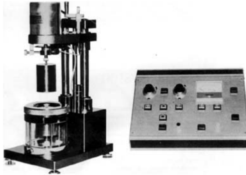
Rys. 4. Profesjonalny lepkościomierz rotacyjny Mark One firmy Deer Instruments (lata 70. XX w.) Źródło: Katalog firmowy Deer Instruments [12]
