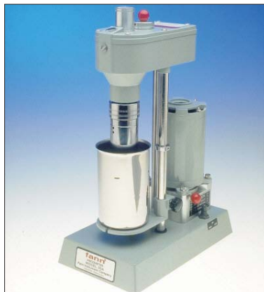
Rys. 5. Lepkościomierz obrotowy Fann z (lata 70. XX w.) Źródło: Katalog firmowy Fann Instruments Company [13]
