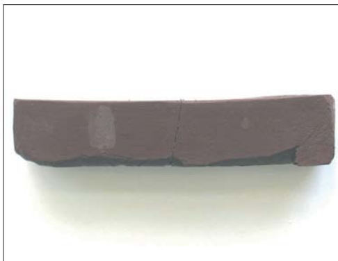
Rys. 3. Skład nr 1, solanka C, 95°C, 365 dni
