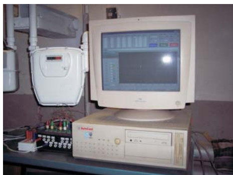
Obr. 4. Provádění kalibrace tlaku v měřicím programu Oscilograf 8.0, vlevo plynové hodiny
