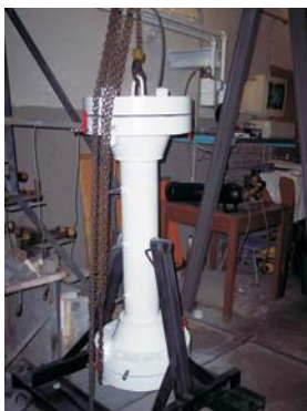
Obr. 3. Měřicí aparatura MAF I ve vertikální poloze – se zapojenými tenzometry
