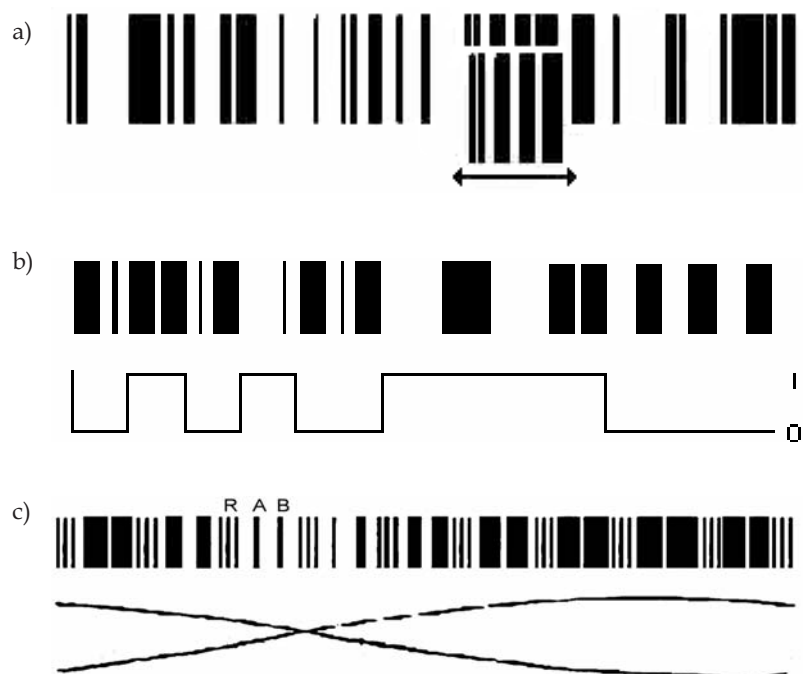
Rys. 2. Kody stosowane w różnych typach instrumentów: a) Wild/Leica; b) Zeiss (Trimble); c) Topcon Źródło: [3]
