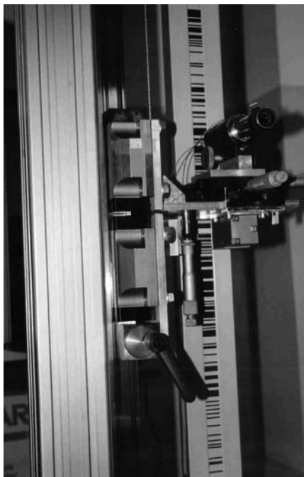
Rys. 4. Układ obserwacyjny komparatora pionowego GLM WGGiŚ AGH
