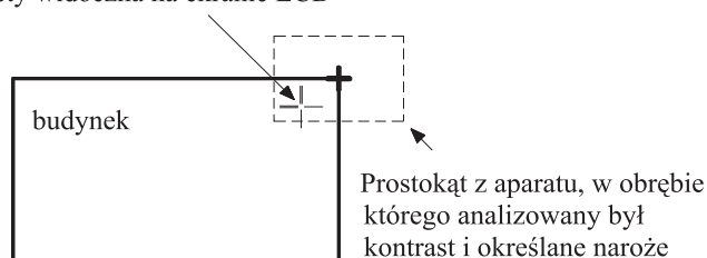
Rys. 6. Widok ekranu LCD tachimetru GPT 7000i podczas pomiaru do naroży budynku
