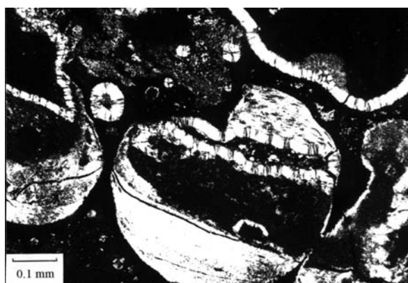
Fig. 4. Różnego kształtu i wielkości wezykule w pierwotnie zeszkliwionym kłaście, w różnym stopniu wypełnione przez minerały ilaste; brekcja zawałowa z kopalni „Marcel” (próbka 6). Płytką cienką; mikroskop polaryzacyjny; polaryzatory X
