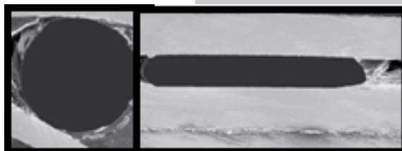
RYS.6. Przekrój drutów rdzenia sprężyny. FIG.6. Cross-section of wires inside the spring core.
