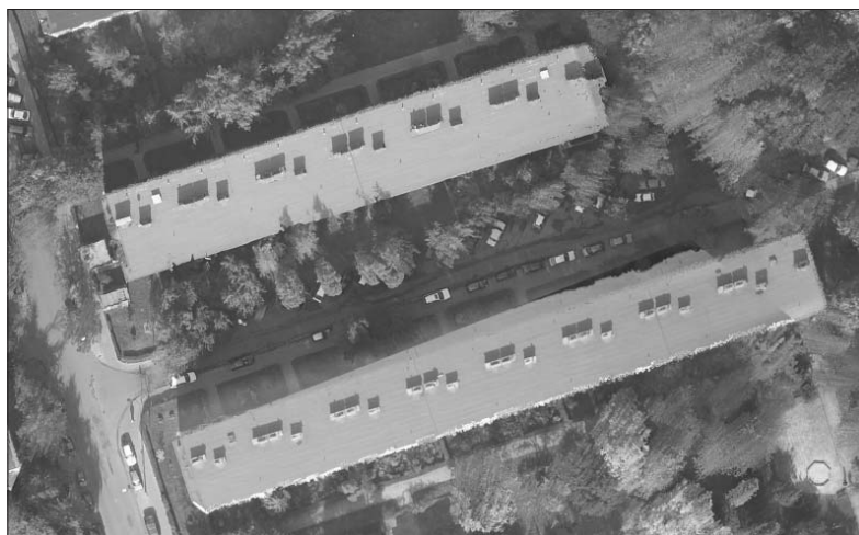
Rys. 6. Fragment ortofotomapy, przy której sporządzaniu do ortorektyfikacji wykorzystano NMPT
