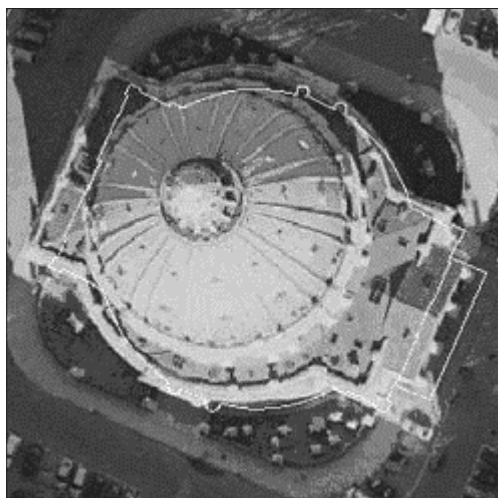
Rys. 1. Wektorowa nakładka nie „pasuje” do zarysu budowli, dach jest przesunięty radialnie w stosunku do podstawy budynku Źródło: [8]
