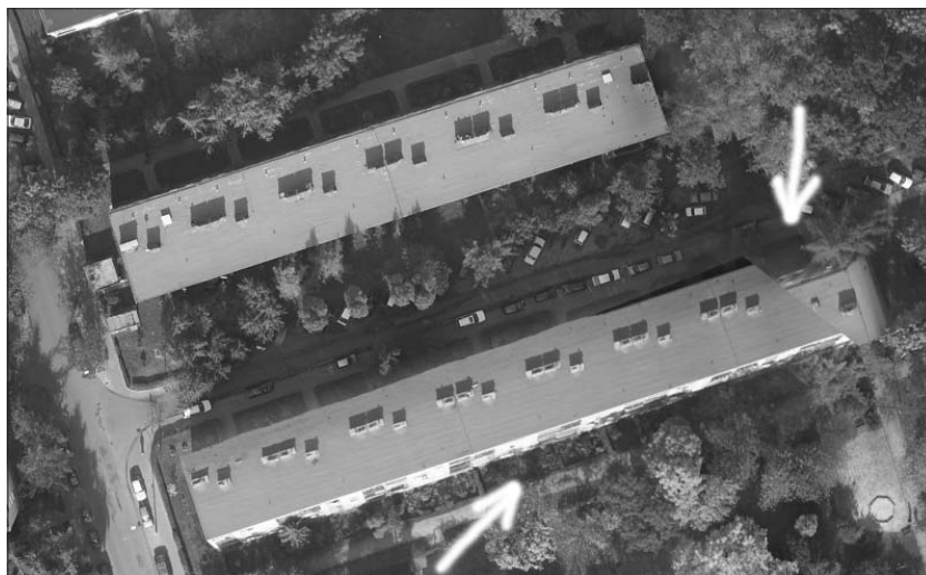
Rys. 5. Fragment ortofotomapy otrzymany na podstawie NMT. Dach budynku jest przesunięty w stosunku do faktycznego położenia. Widoczne są także uskoki dachu spowodowane automatycznym mozaikowaniem
