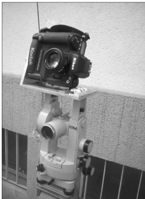
Rys. 2. Kamera Kodak DCS 760 zamocowana na teodolicie Theo 010B jako zestaw fotogrametryczny do wykonywania zorientowanych zdjęć nachylonych w celu pomiaru wychyleń wysokich obiektów
