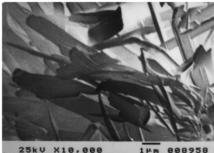
Rys. 9. SEM. Mikrostruktura stwardniałego zaczynu żużlowo-alkalicznego z dodatkiem 10% zeolitów klinoptilolitowych, poddanego autoklawizacji. Widoczne dobrze skryształizowane wstęgowe formy hydrogranatów; pow. 10 000 ×
