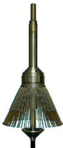
Rys. 2. Średnicomierz wieloramienny MIT SONDEX 80
