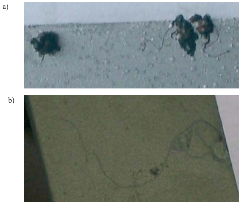
Rys. 4. Korozja wżerowa i nitkowa wywołwana przez badane ciecze nadpakerowe w temperaturach +5 i –15°C: a) przed usunięciem produktów korozji; b) po usunięciu produktów korozji
