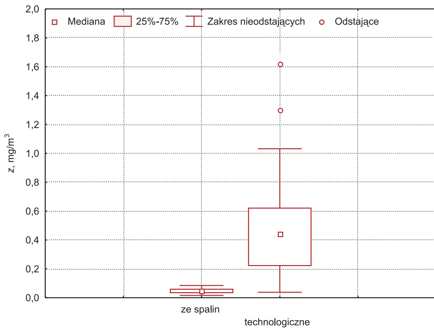
Rys. 7. Zakres stężeń pyłów w wyrobisku ze spalin i pyły technologiczne przy maszynie odstawiającej urobek
