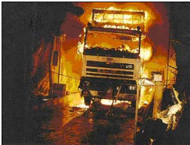
Rys. 2. Zdjęcie HGV wykonane podczas przeprowadzania badania pożarowego
