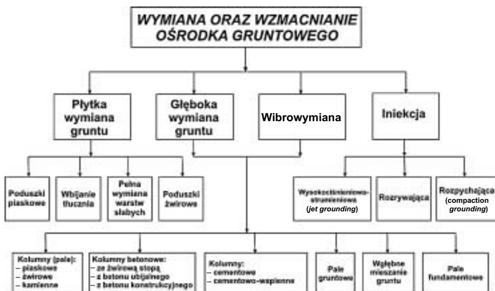
Rys. 5. Klasyfikacja metod wymiany oraz wzmocnienia ośrodka gruntowego [1, 2, 3, 4, 8]
