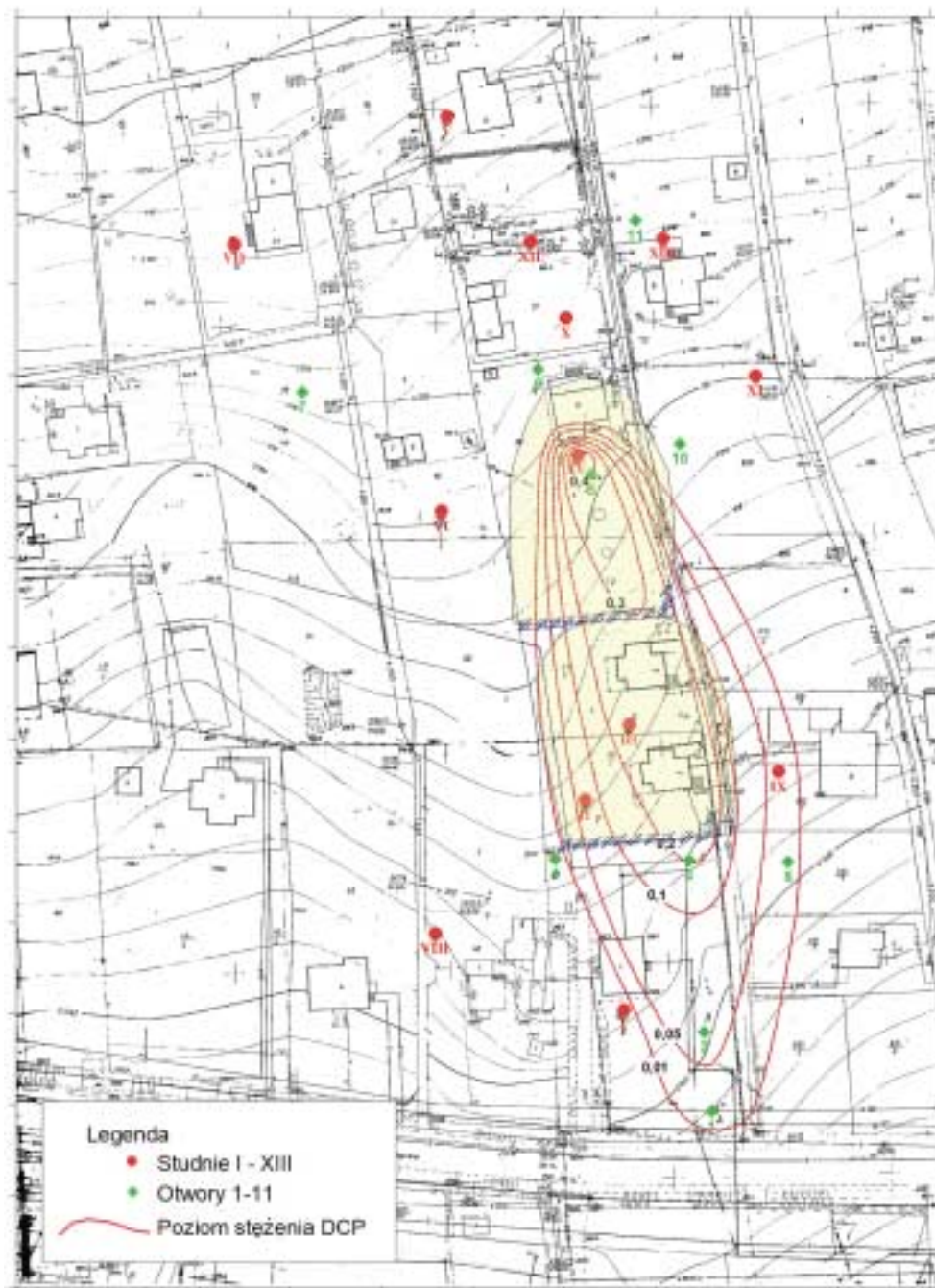
Rys. 4. Proponowane rozmieszczenie otworów tłocznych w dwóch bateriach po 12 otworów rozmieszczonych wzdłuż ogrodzeń posesji – seria „a” i seria „b”
