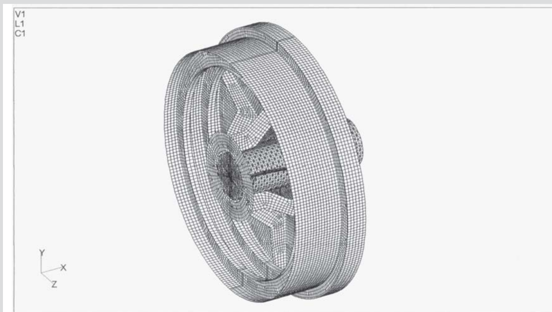
Rys. 3. Podstawowy model obliczeniowy bębna pędno – MP
