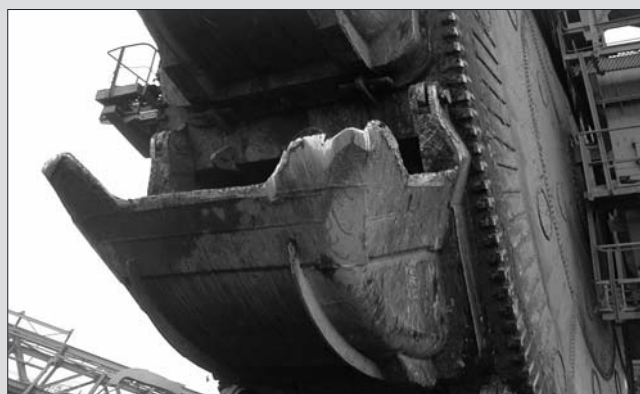
Rys. 1. Zużyte naroże czepaka R-40 na koparce SchRs 4000
