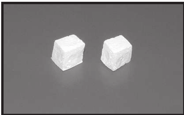
RYS. 2. Otrzymane materiały porowate. FIG. 2. Photo of obtained sinters.
