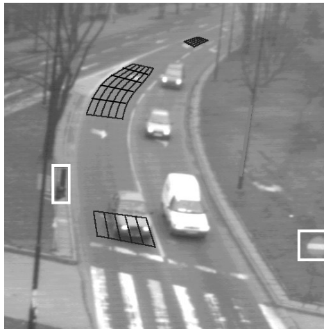
Rys. 1. Redukcja informacji obrazowej w celu symulacji pętli indukcyjnych (linie czarne) oraz elementy konfiguracyjne krakowskiego wideodetektorza (białe prostokąty)
