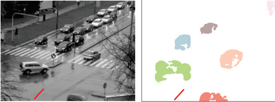
Rys. 4. Przykład prawidłowego śledzenia obiektów nie przesłaniających się
