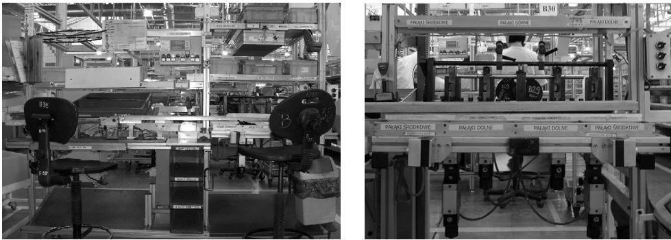
Rys. 1. Linia montażu wycieraczek samochodowych
