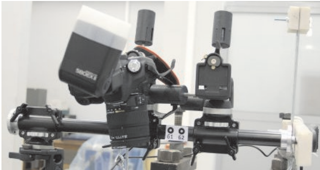
Rys. 6. Aparat fotograficzny zamontowany na poziomym statywie
