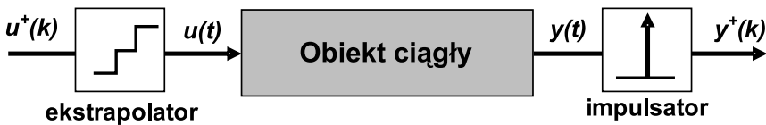
Rys. 1. Ciągły obiekt regulacji z ekstrapolatorem i impulsatorem
