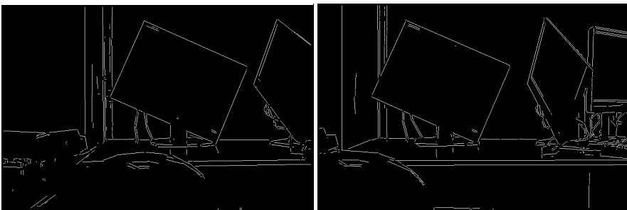
Rys. 3. Wynik procesu wektoryzacji przy wykorzystaniu algorytmu Canny’ego
