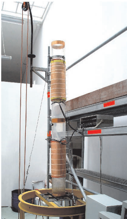
Rys. 2. Stanowiska badawcze: a) widok ogólny; b) rozmieszczenie elektrod pomiarowych wokół silosu (z rozkład materiału wewnątrz czujnika o przenikalności \epsilon ) oraz trójkąt pomiarowy dla 12-elektrodowego czujnika
