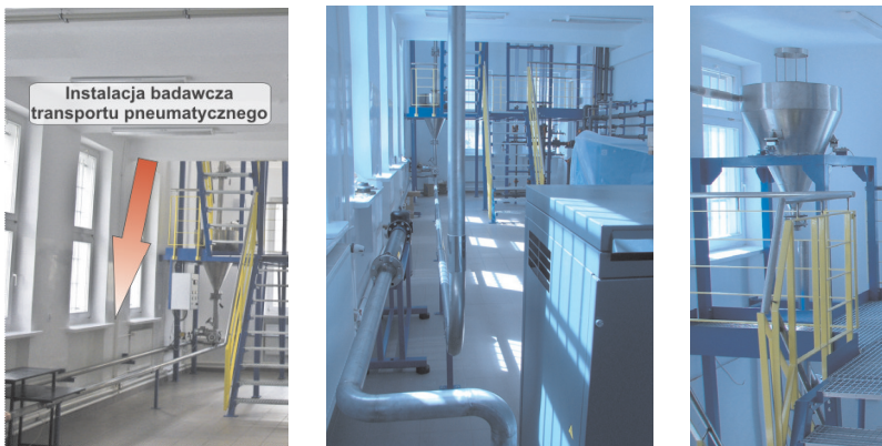
Rys. 2. Fotografia przedstawia półprzemysłowe stanowisko badawcze transportu pneumatycznego w laboratorium im. Tomasza Dyakowskiego w Katedrze Informatyki Stosowanej
